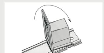
Bajo petición con dispositivo de bloqueo para un repuesto mas fácil, por ejemplo FIFO.
