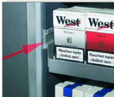
El estante matic POS-7 con función FiFo, hecho de metal ligero, anodizado naturalmente, con rieles de cajón en plástico, sistema de retención, empujador POS-7 2 Newton con porta etiqueta, y separadores de 60mm de alto.
